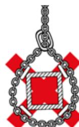
Si les chaînes sont montées autour d'une charge (bras de supports), le diamètre doit être au minimum de 3 fois le pas de la chaîne (longueur intérieure du maillon). Si l'on utilise un diamètre inférieur, la capacité de charge doit aussi être réduite de 50 %.
