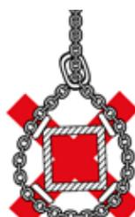
Om kättingar leds runt om lasten (t.ex. bärarmer) bör diametern på dessa vara åtminstone 3 x kättingdelningen (den inre kättinglänkens längd). Vid en mindre diameter måste kättingens bärformåga reduceras med 50 %. Om kättingar leds runt om kanter utan korrekt skydd måste även kättingens bärformåga reduceras. Kriteriet för
