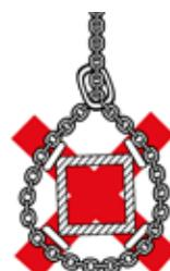
Likeså må kjettingenes bæreevne reduseres dersom de legges rundt kanter uten korrekt beskyttelse. Kriteriet for korrekt beskyttelse og reduksjonsmålet ved dårlig eller manglende beskyttelse er avhengig av radiusen på kanten kjeden legges over. I denne sammenheng er det likegyldig om det handler om kanten på godset eller kanten på
